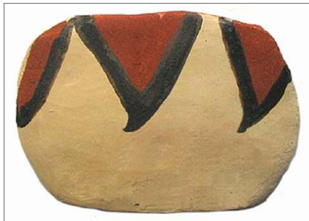
Рис. 5. Экспериментальный образец с черным ангобом, разведенным на желтке. Горячий образец покрыт расплавленным воском.
